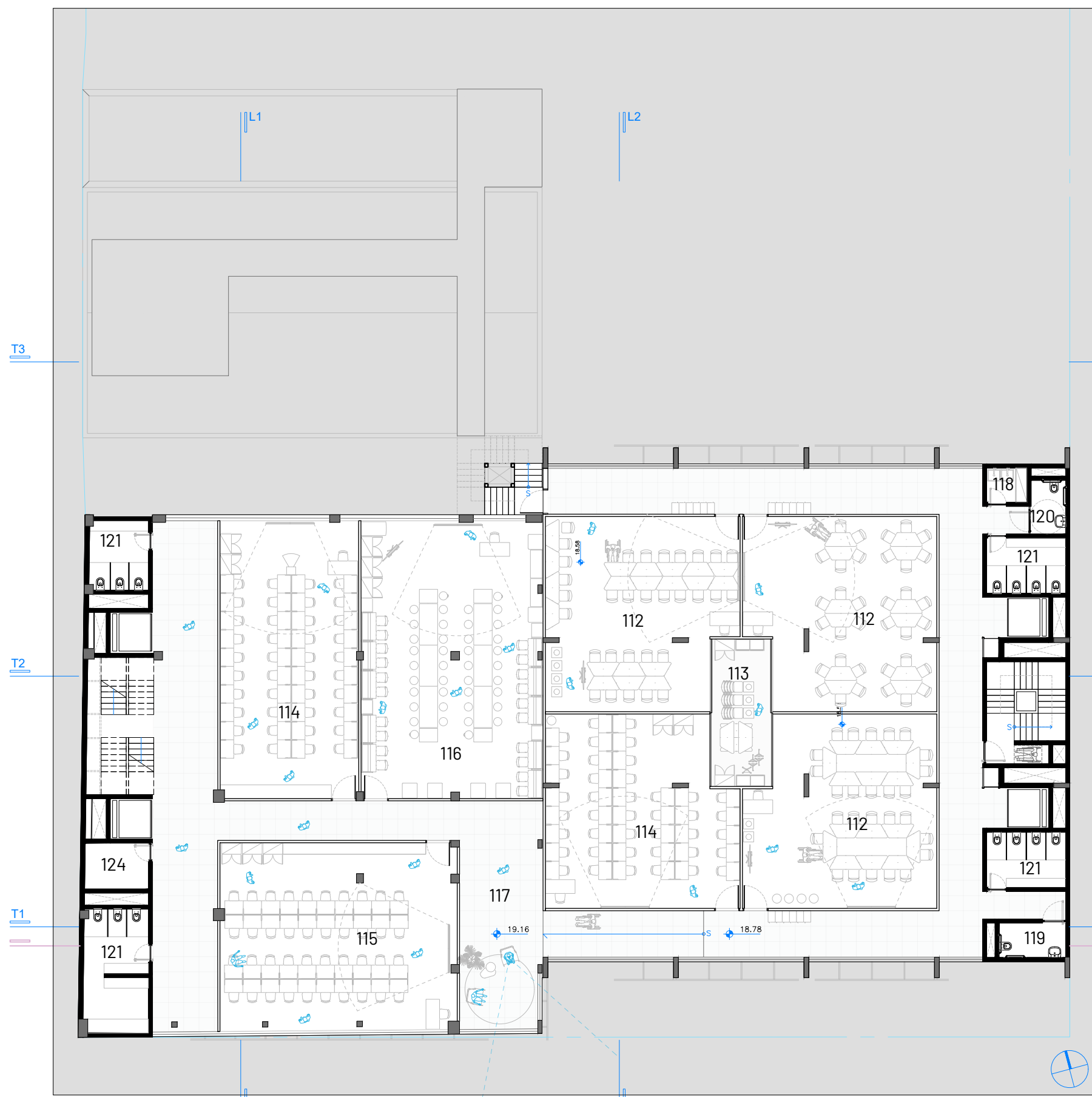
pavimento tecnologia | bloco 2 nível +19,16 | bloco 1 nível +18,78 1:200
